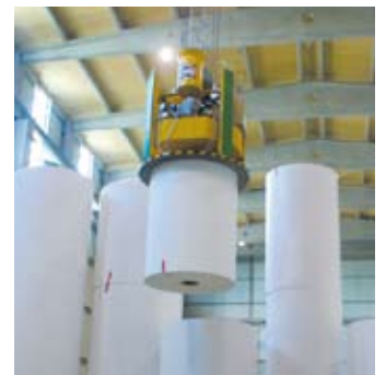
Der VacuCoil beim Einsatz im Logistikbereich einer Papierfabrik
