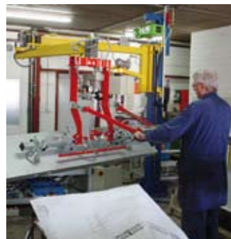
Knickarmausleger VacuMat beim Beschicken eines Fördersystems
