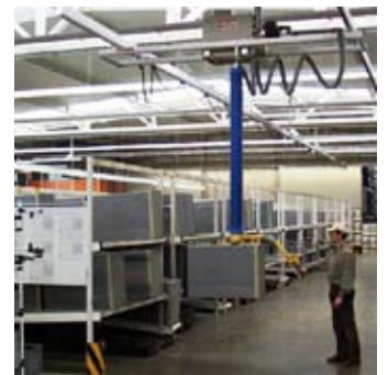
Hängebahnsystem mit Schlauchheber VacuPowerlift
