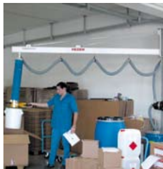
Leichtgängiger Säulenschwenkran mit Alu-Schienenensystem
