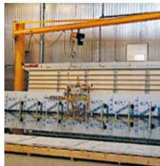
Säulenschwenkkrane mit schwenkbarem Handhabungsgerät VacuBoy
